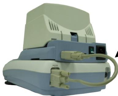
1. Cavo collegamento riscaldatore bilancia 9 poli M/F
