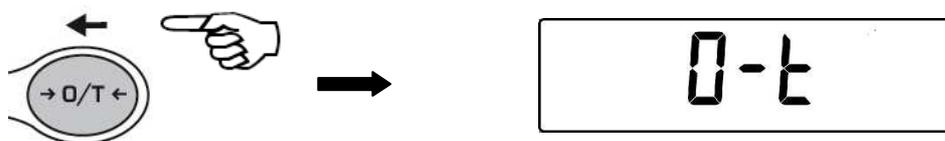
3. Raggiunta la stabilità verrà visualizzato il valore di zero "0.000". Nel caso in cui non venisse raggiunta la stabilità per correnti d'aria, vibrazioni o altri tipi di disturbo la scritta "O-t" continuerà ad essere visualizzata.
