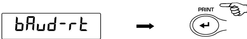
2. Selezionare la velocità di trasmissione dati seriale (1200-2400-4800-9600 baud) Premendo il tasto **MENU** o **CAL** sarà possibile scorrere in avanti o indietro le diverse velocità di trasmissione, confermare poi la scelta con il tasto **PRINT**
